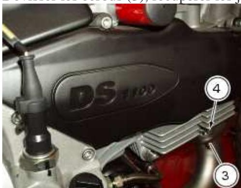
Repose du système d'échappement
