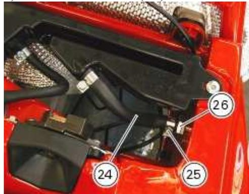
Déposer la tubulure du réservoir de récupération des liquides/réservoir d'essence (24) en dévissant le collier (25) du raccord (26) : récupérer le joint torique (27).
