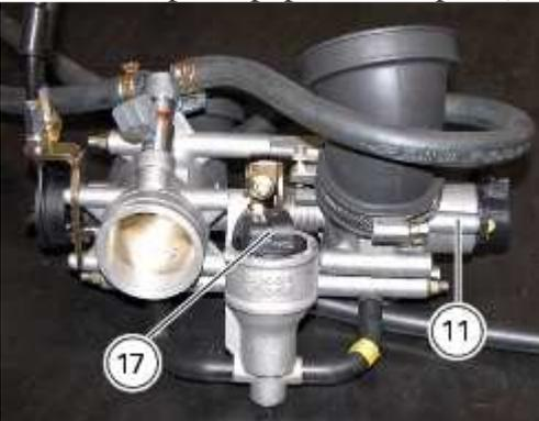
**Dépose du potentiomètre**
