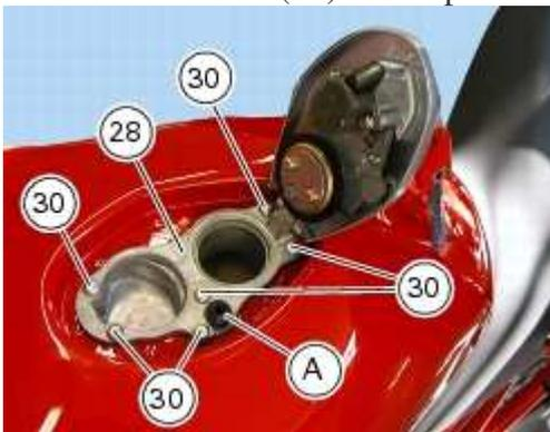
Le bouchon du réservoir contient le tuyau (A) de mise à l'air libre.
