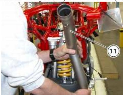
Pour installer le collier (27) de fixation du tuyau (11) au pré-silencieux (10), l'orienter de manière à ce que la vis soit parallèle à l'axe passant par les découpes (A) du tuyau. Poser le collier de serrage (27) de manière à ce qu'il arrive au ras du tuyau ou, de toute façon, sans couvrir entièrement les découpes (A). Serrer le collier (27) au couple spécifié (Sect. C 3, [Couples de serrage du cadre](#)).
