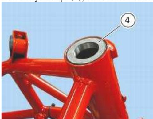
Graisser la bague (3) ; visser à la main la bague de réglage (3) jusqu'à ce qu'elle arrive en butée contre le joint spi (4).
