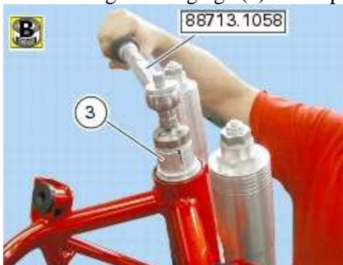
Reposer le té supérieur (2) sur la bague fileté (3) en alignant les logements sur les tubes de fourche avec les logements correspondants sur le té inférieur. Reposer les tubes de fourche comme décrit à la Sect. G 2, [Repose de la fourche avant](#) (1100S)/[Repose de la fourche avant](#) (1100).
