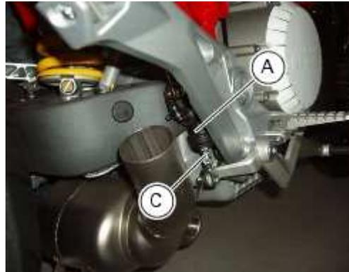
Installer le repose-pied gauche (14) sur les fixations du carter moteur avec les rondelles (2).
