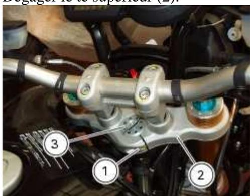
À l'aide de l'outil réf. 88713.1058 desserrer la bague (3) et la dévisser du pivot de direction.
