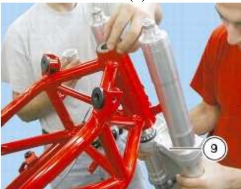
Enfiler sur la bague extérieure supérieure (C) du cadre la couronne de billes (B) en vérifiant qu'elle est bien graissée.
