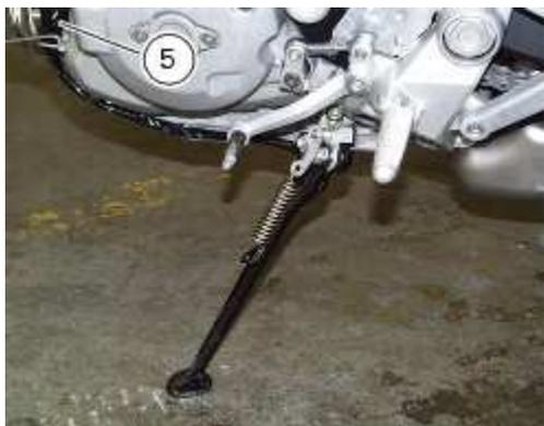
Dévisser les deux vis (2) fixant le support (3) de la béquille au moteur et déposer la béquille latérale complète.
