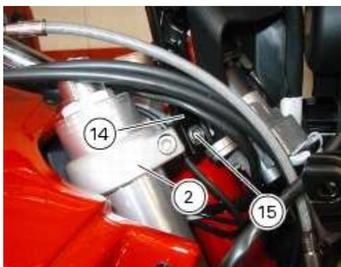
Desserrer la vis (1) de blocage du té supérieur (2) sur la bague fileté (3).
