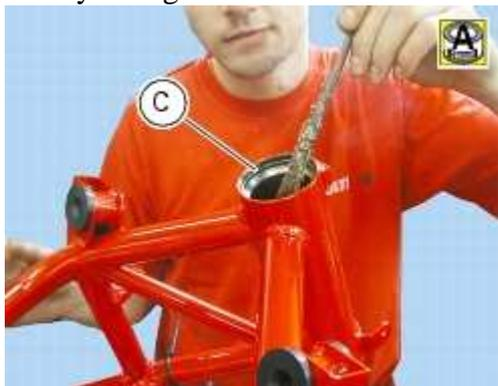
Pour poser les bagues extérieures (C) des roulements (5) et (6) sur la colonne de direction, il faut utiliser l'outil 88713.1062 et procéder comme suit :
