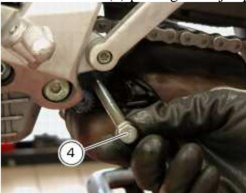
Serrer l'écrou (5) au couple spécifié (Sect. C 3, [Couples de serrage du cadre](#)) sur la vis (4) en passant par la droite.
