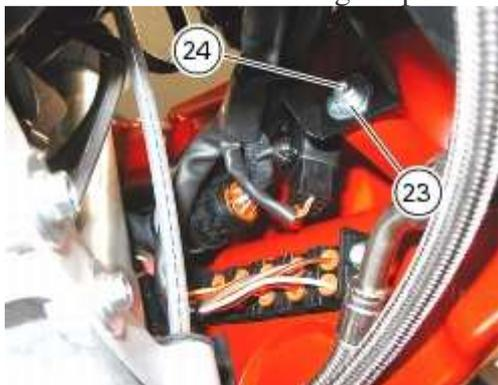
En passant par le haut, dévisser l'autre vis (24) avec rondelle (23) et déposer le demi-carénage supérieur gauche en le dégageant des pions du réservoir.
