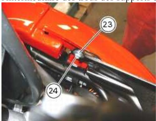
Serrer les vis (24) au couple spécifié (Sect. C 3, [Couples de serrage du cadre](#)).
