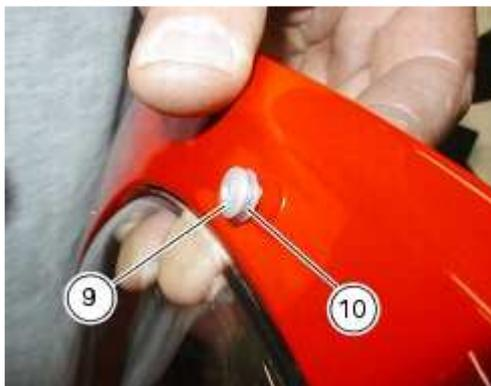
Introduire les écrous caoutchouc (11) et serrer les vis (9) comme décrit dans la Sect. C 3, [Couples de serrage du cadre](#).
