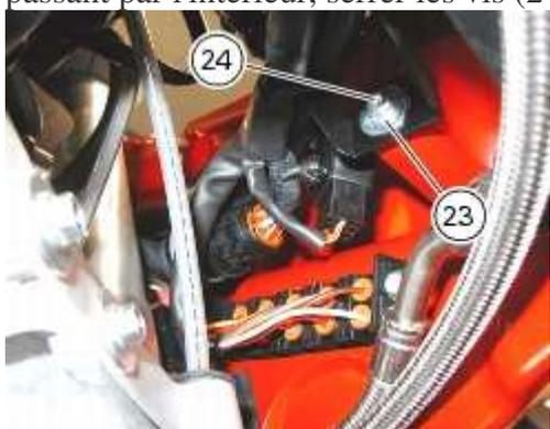
Avant de bloquer les vis (24), poser le demi-carénage gauche et le déflecteur frontal en vérifiant la correspondance des profils des composants : il est possible de corriger légèrement les positions par l'intermédiaire des trous des supports du faux-cadre de soutien du phare.
