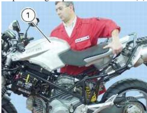
Le groupe selle-réservoir comprend les éléments suivants : la selle (22) fixée avec les vis (2) et les rondelles (15).
